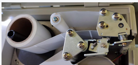
Figura 3. Rollo de etiquetas y mecanismo de rebobinado (referencia)
